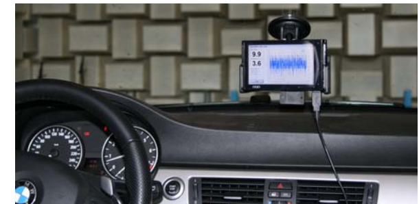
Abbildung 1: Im Fahrzeug installierter Shift-Comfort Assistant SCA
