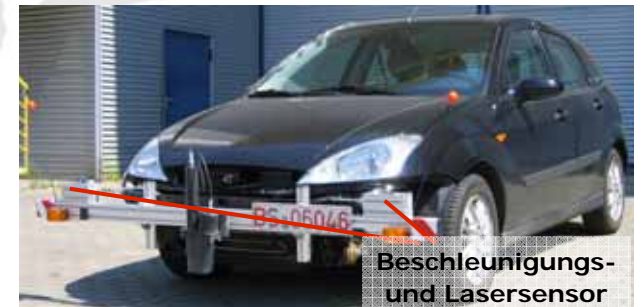
Bild 2: Unebenheitsmesssystem des IfF
