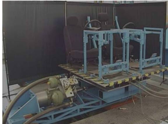
Bild 1: Servohydraulischer Schwingungsprüfstand mit vier Freiheitsgraden
